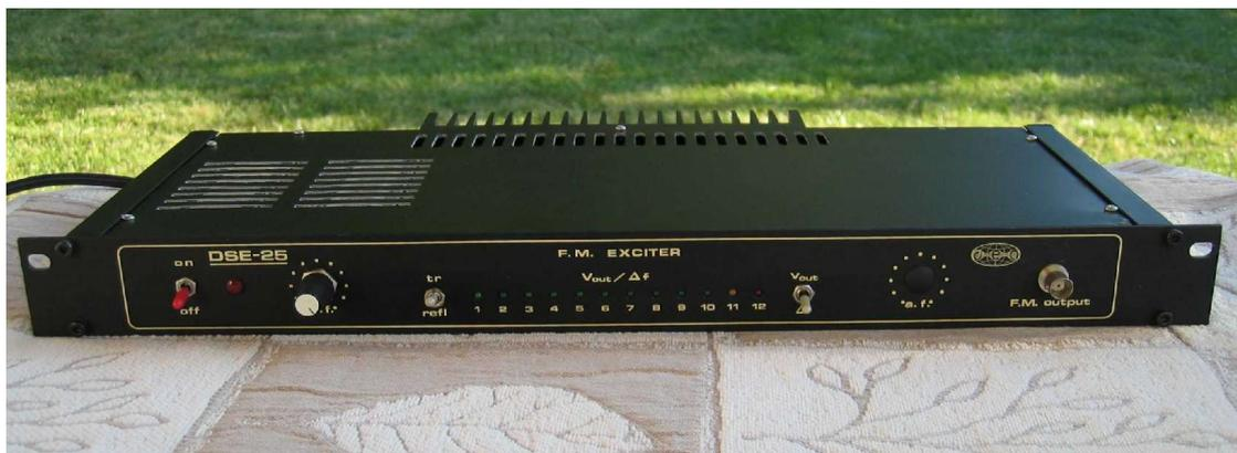
Le pilote synthétisé DSE-25 DS est une variante du pilote DSE-25, prévue pour les réseaux de diffusion synchrone (autoroutes, par exemple).
