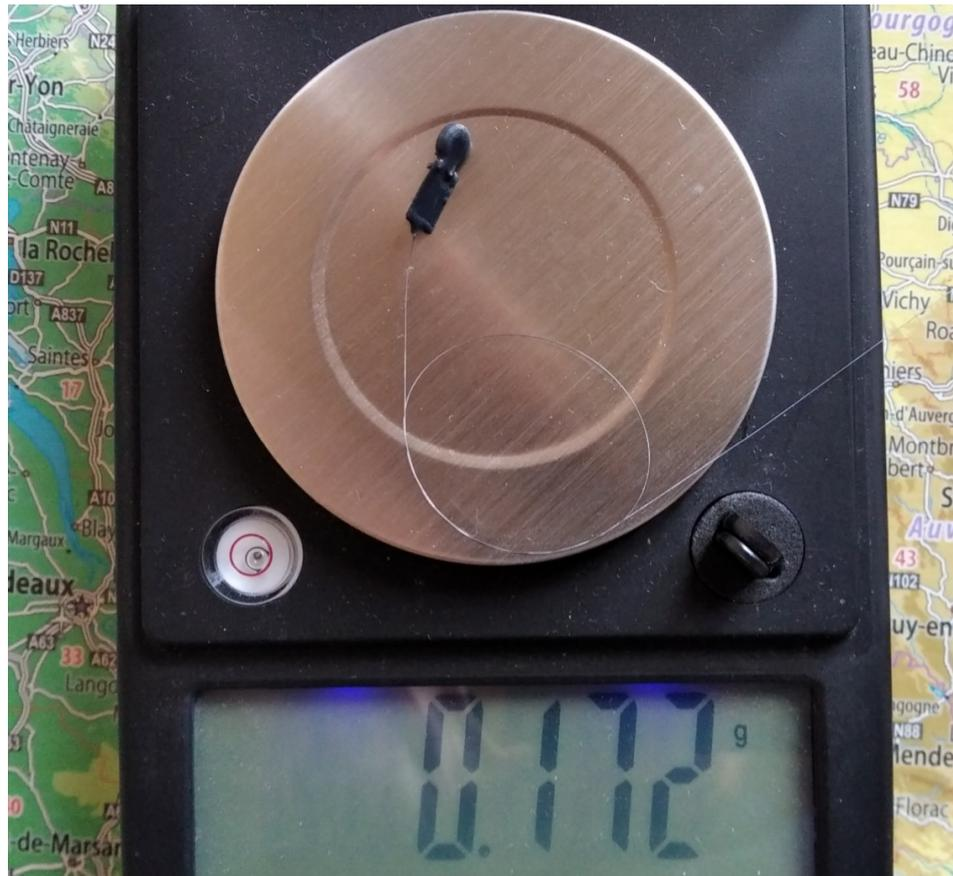
Les émetteurs TRTX-2 peuvent être conservés pendant 2-3 semaines avant d'être utilisés sans perte sensible de durée de fonctionnement. L'activation se fait par la suppression d'une petite boucle en fil très fin - opération à la portée de tous et sans aucun équipement spécial.
